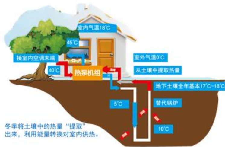
图 4 地源热泵系统（浅层地热能供热）
