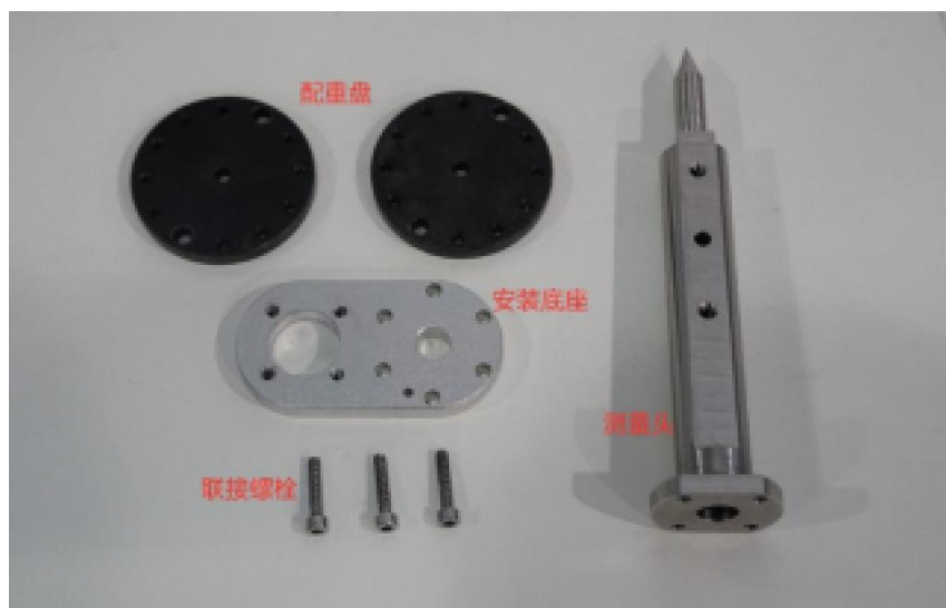
图 4-1 位姿准确度及位姿重复性检测用测量头
