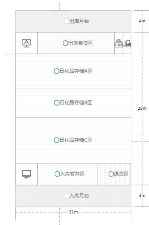
现需要对仓储配送中心所需仓储设备进行选型及数量估算，根据前期对仓储配送需求的调研，确定该仓储配送中心基于 ABC 分类（按照商品周转率高、中、低来分类）进行库房布局，该项目相关信息如下：
