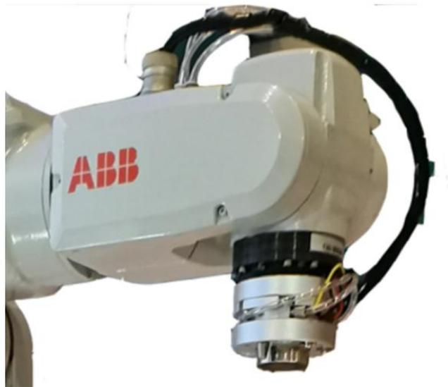
图 1-2 末端执行器连接后的效果
